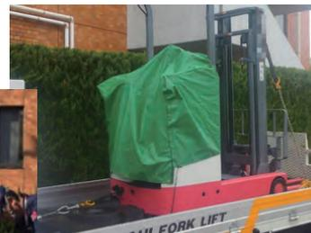
◀ウィンチとレバーブロックでフォークリフトを固定している様子
