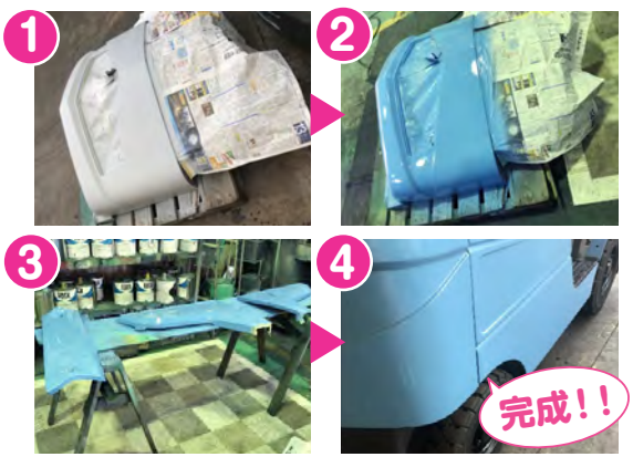
パーツを全て外して下地から塗装している様子
